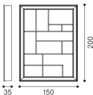
Pensile sospeso ruotabile con cornice e scaffali. Senza schiena / *Adjustable wall-hung unit with frame and shelves. Without back*
